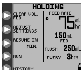
Rysunek 18A. Opcje trybu HOLDING (wstrzymanie), ciągle tryb żywienia.
